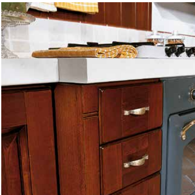
Top Laminato bordo raggiato sp. 4 cm Laminate Worktop round edge th. 4 cm
